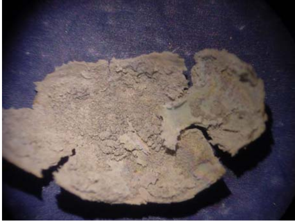
Fig 7: Cáscara de maní con cemento, externa
