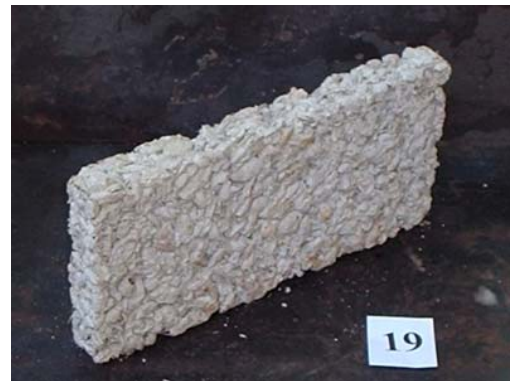
Fig 10: Ladrillo de cáscara de maní (L19) con cemento + aditivos
