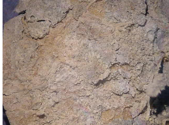
Fig 6: Cáscara de maní con cemento, interna
